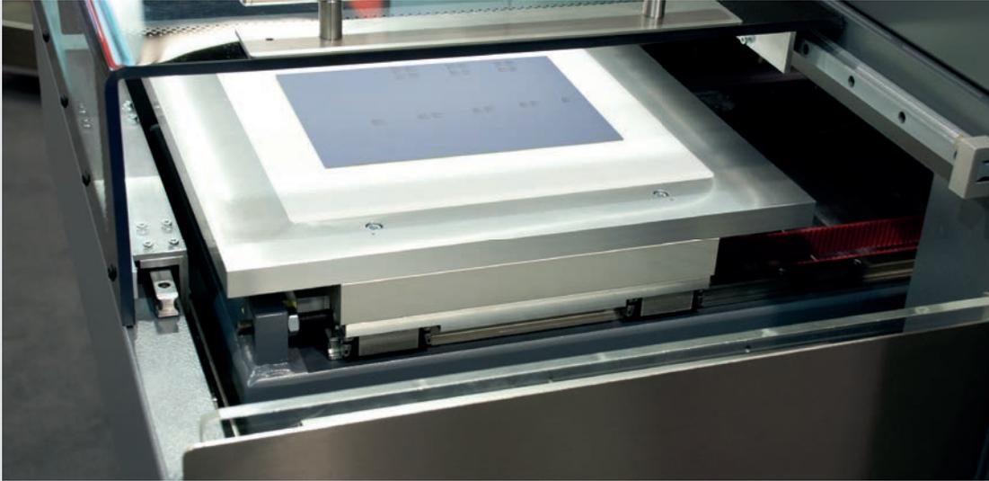
Seitlich ausfahrbarer Drucktisch zum Beladen des Drucksystems / Retractable table for loading the print system.
